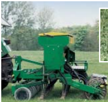
Le semoir Aitchison conserve le système d'ouverture en T inversé qui limite les lissages et le dessèchement de la ligne de semis tout en facilitant la fermeture.
